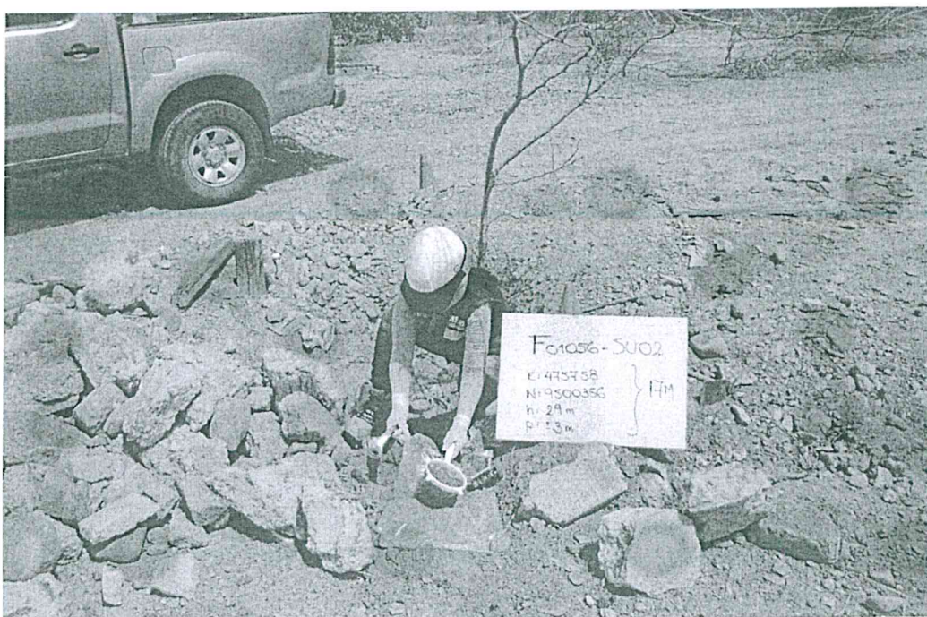
Fotografía N° 2. Toma de muestra en el punto F01056-SU02, ubicado a 1,5 m de distancia del casing del pozo T4797 a una profundidad de 0,3 m de la superficie del suelo.
