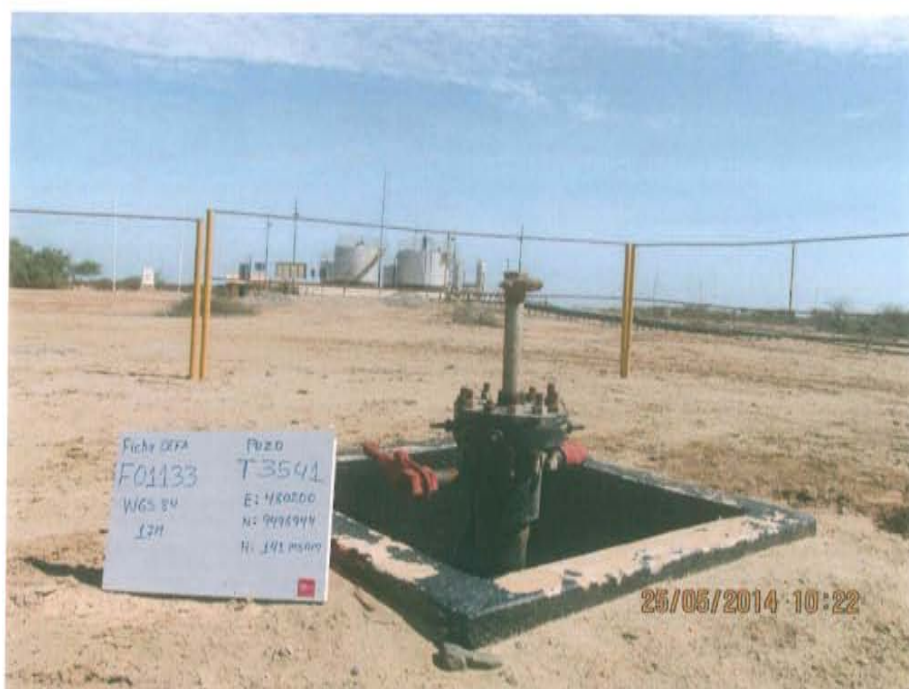
Fotografía N° 1. Pozo inactivo, presenta válvula mariposa y de bloqueo, en un área cercado dentro de cantina.
