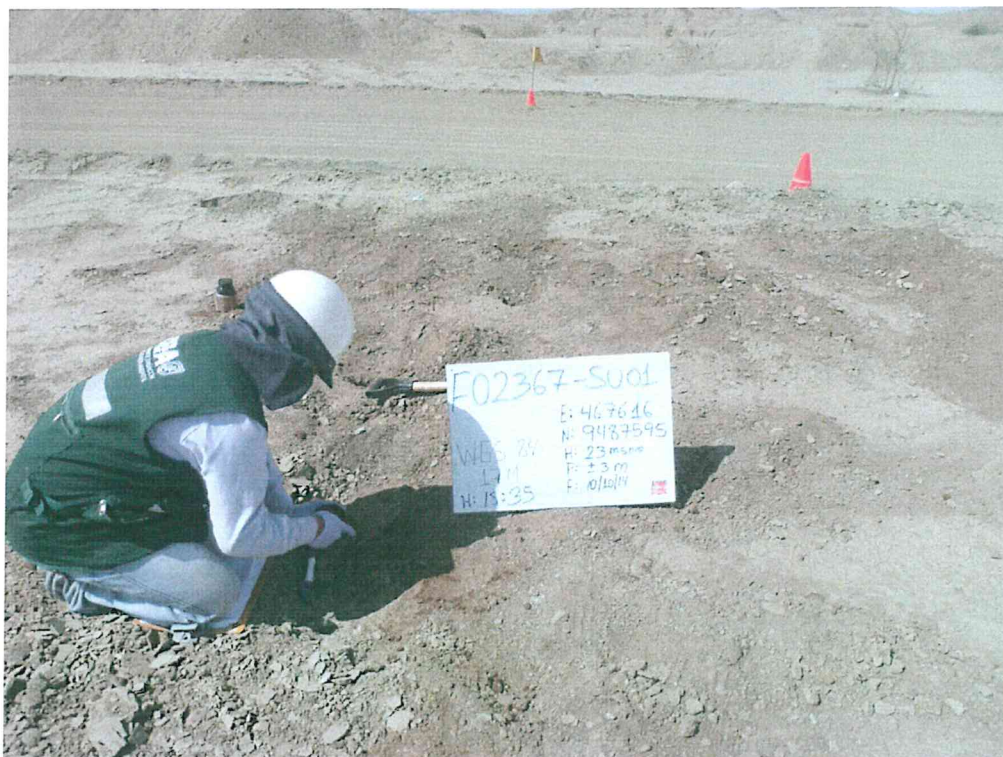
Fotografía N° 3. Toma de muestra de suelo en el punto F02367-SU01, ubicado aproximadamente a 4 m al noroeste del Pozo T_361.
