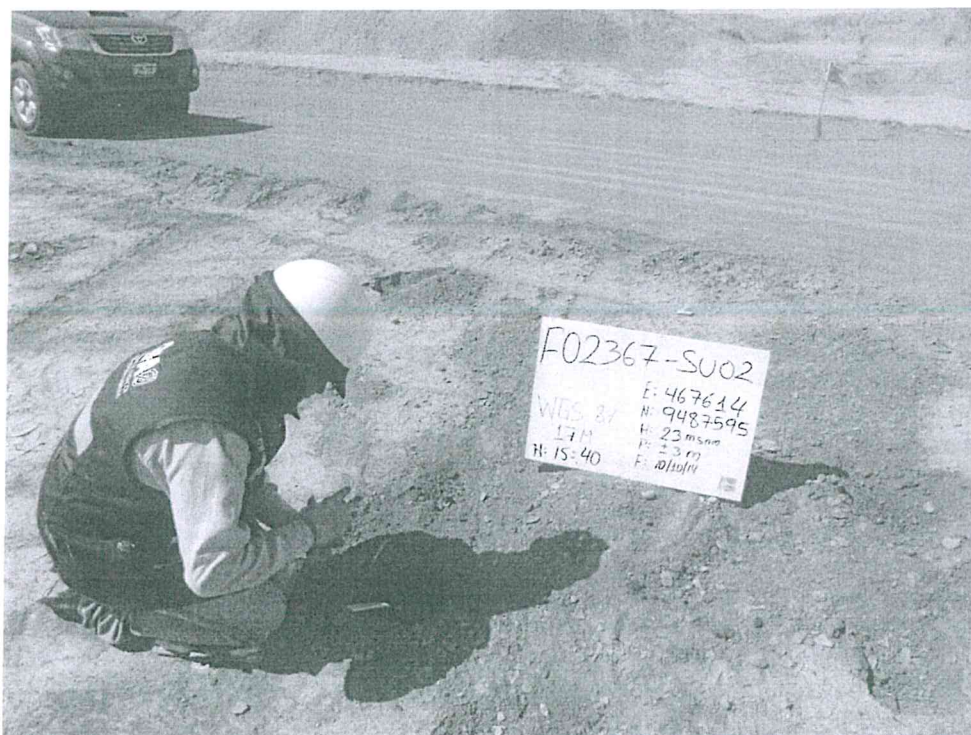
Fotografía N° 2. Toma de muestra de suelo en el punto F02367-SU02, ubicado a 5,2 m de distancia, al noroeste de la posible ubicación del Pozo T_361.
