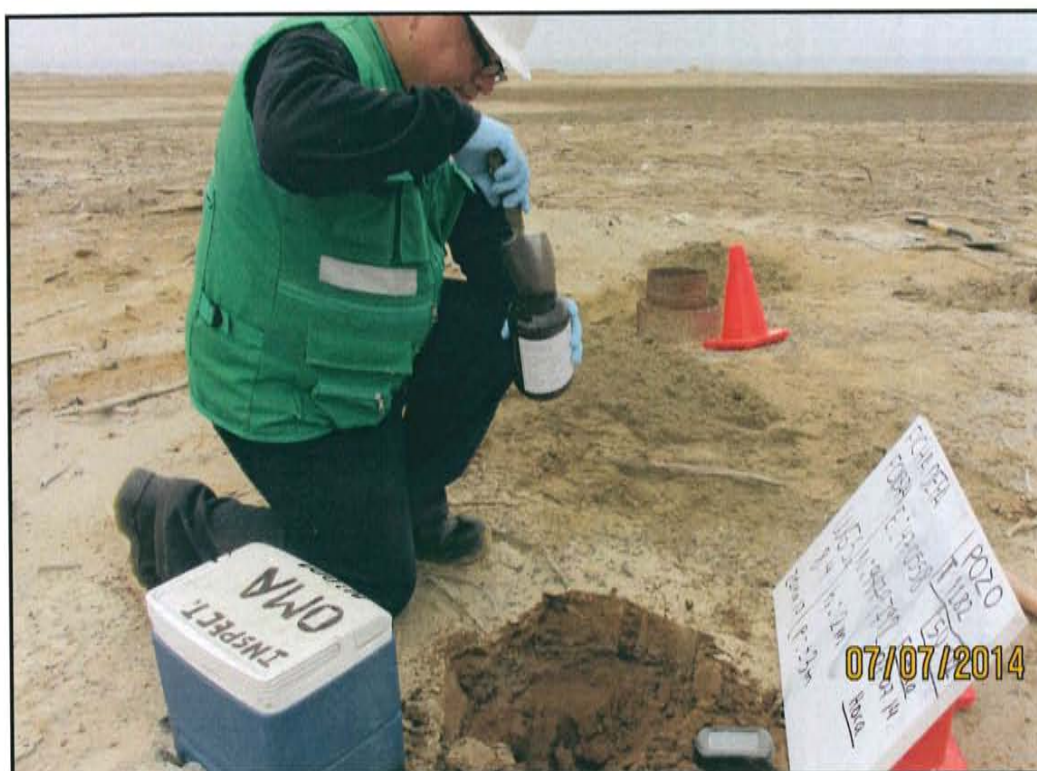
Fotografía N° 4. La muestra de suelo F01374-SU02 fue tomada a 2,15 m de distancia del casing del Pozo T1182.
