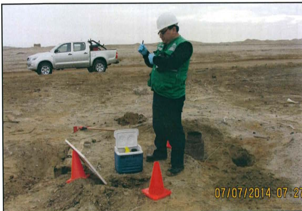
Fotografía N° 3. La muestra de suelo F01374-SU01 fue tomada a 1,3 m de distancia del casing del Pozo T1182.
