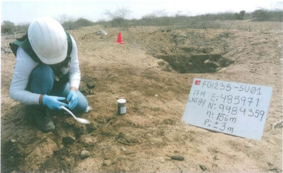
Fotografía N° 03.- Toma de muestra de suelo en el punto F01235-SU01, ubicado a 3,1 m aproximadamente del Pozo T2428.
