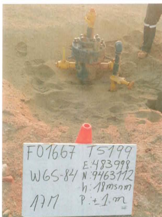
Fotografía N° 1. Se observa que el Pozo T5199 presenta cabezal compuesto por brida y válvulas (concéntricas y laterales).
