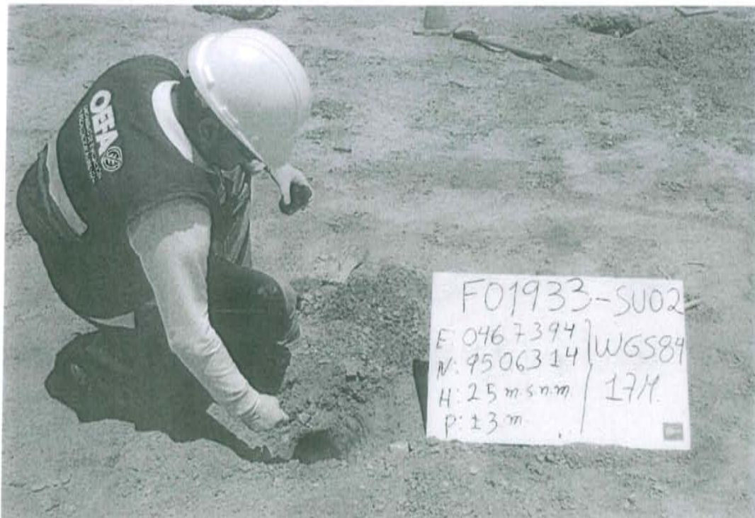
Fotografía N° 2. Toma de muestra de suelo en el punto F01933-SU02, ubicado a 9,5 m aproximadamente del Pozo L1516.
