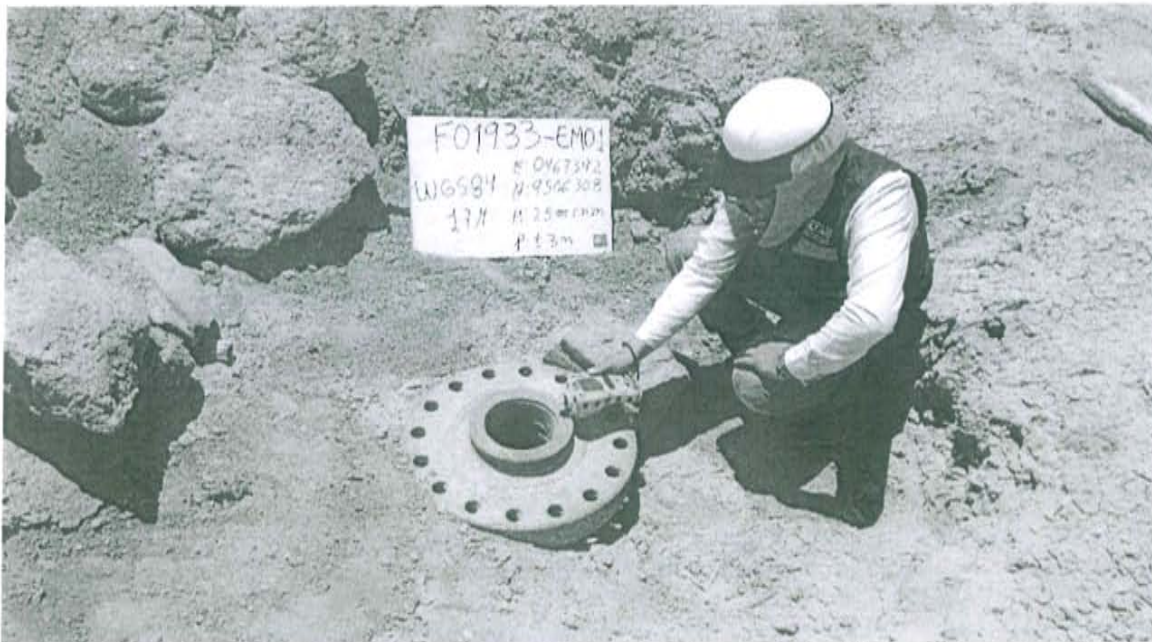
Fotografía N° 2. Mediciones en el F01933-VA01, se realizó en un recorrido en el área circundante alrededor del Pozo en un radio de 1 m, con una duración de 10 minutos.
