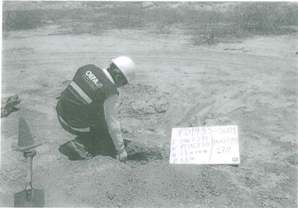
Fotografía N° 1. Toma de muestra de suelo en el punto F01933-SU01, ubicado a 5 m aproximadamente del Pozo L1516.
