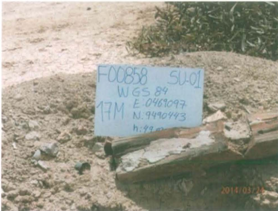
Fotografía N° 3. Punto de muestreo de suelo F00858-SU01 a 0,80 m del casing, a una profundidad de 0,85 m de la superficie del suelo.
