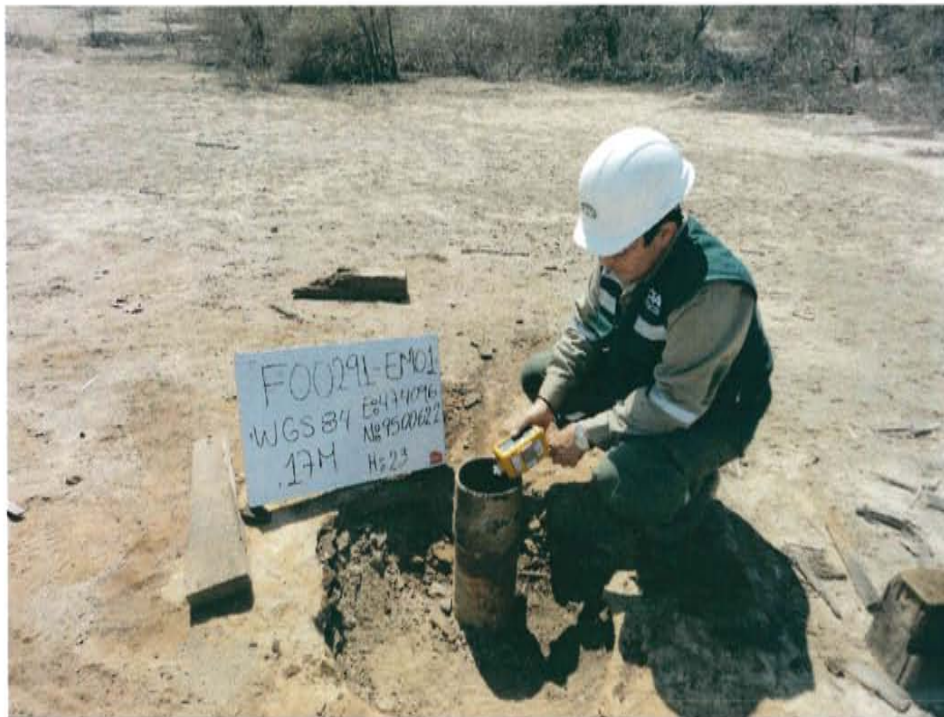
Fotografía N° 4. Medición de emisiones fugitivas en boca de pozo.
