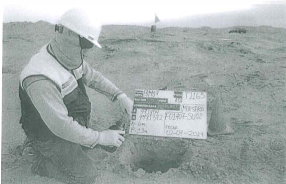
Fotografía N° 2. Toma de muestra de suelo en el punto F01407-SU02, ubicado a 9 m de distancia del Casing, Pozo T1165.
