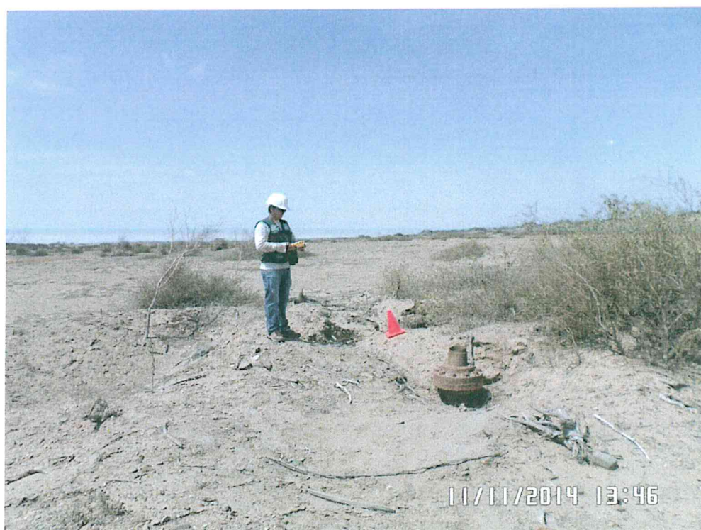
Fotografía N° 4. Mediciones en el F02767-VA01, se realizó en un recorrido en el área circundante alrededor del Pozo T3717 en un radio de 1 m, con una duración de 10 minutos.
