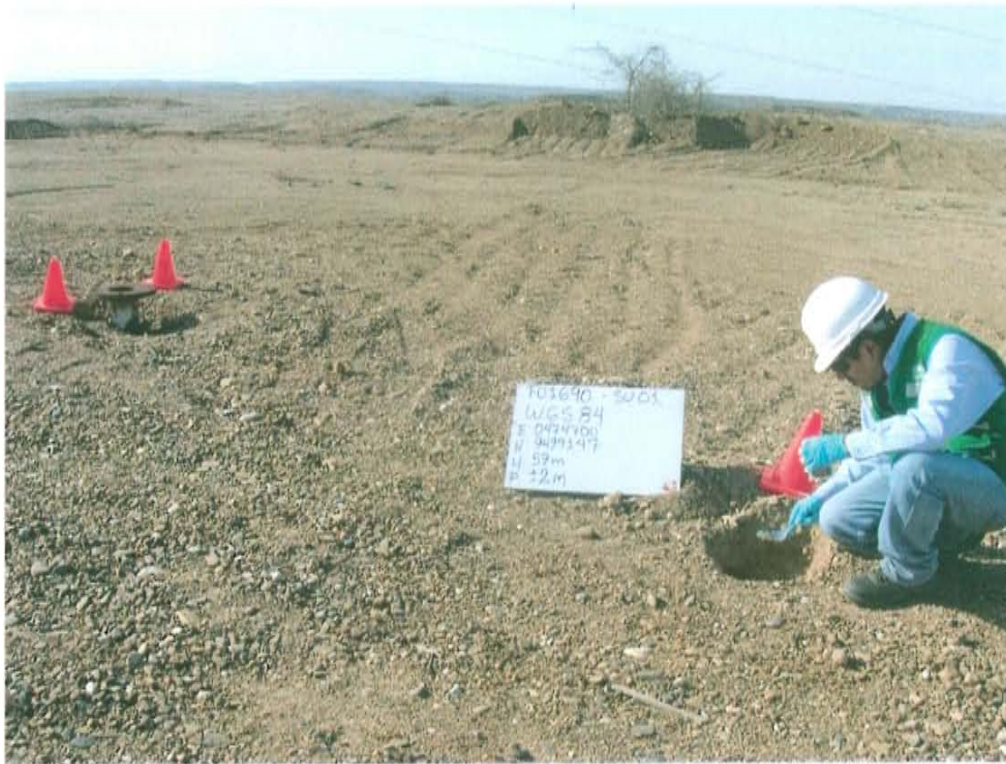
Fotografía N° 3. Toma de muestra de suelo en el punto F01690-SU01 ubicado a 7 m al sur del Pozo T3353.
