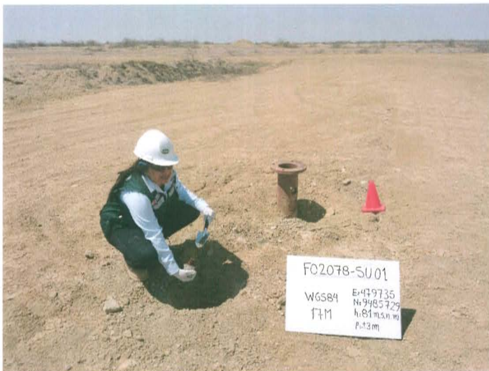
Fotografía N° 3. Toma de muestra de suelo en el punto F02078-SU01, ubicado a 2 m aproximadamente del Pozo T2297.
