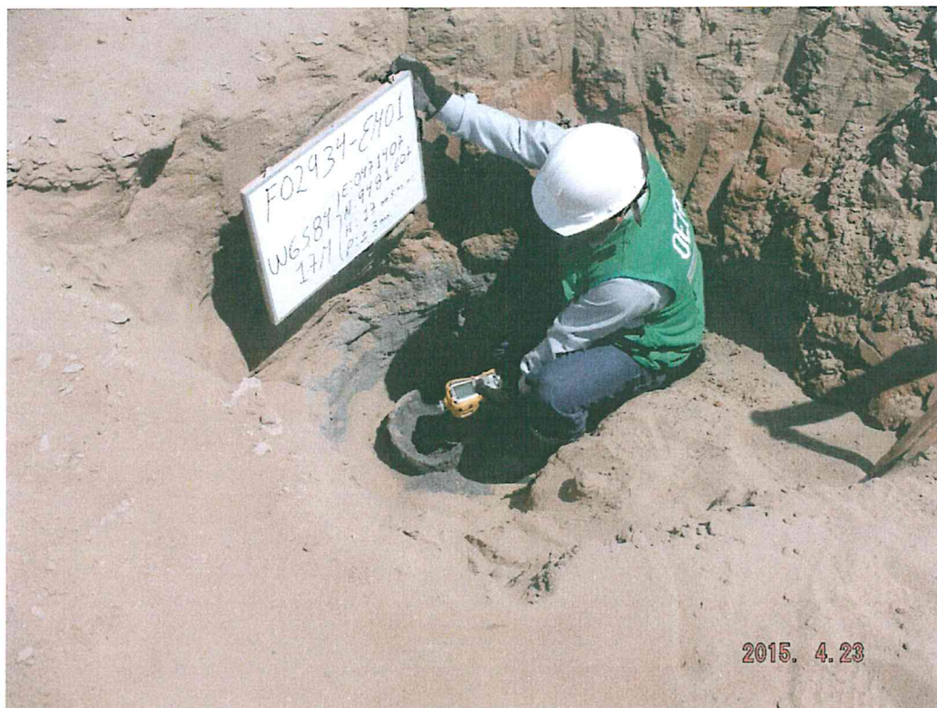
Fotografía N° 5. Vista de la medición de emisiones con código F02934-EM01, ubicado en boca del pozo T1604.
