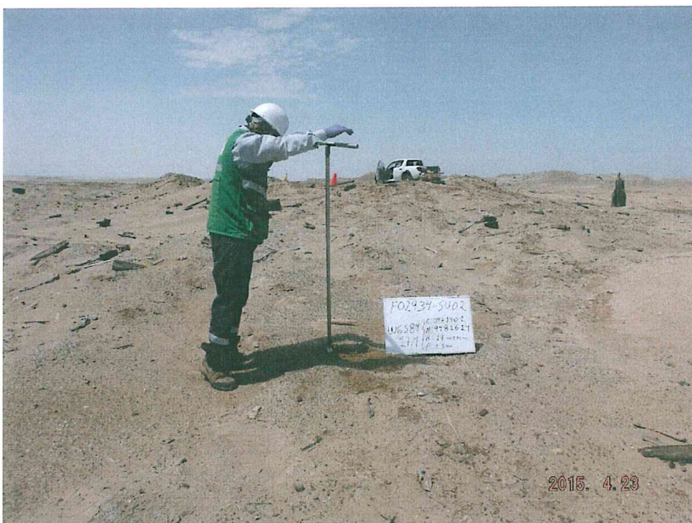
Fotografía N° 4. Toma de muestra de suelo en el punto F02934-SU02, ubicado a 8 m en dirección noroeste del Pozo T1604.
