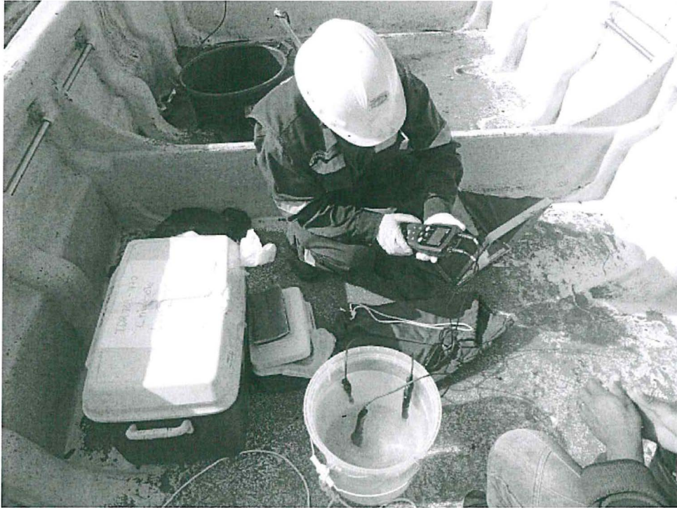
Fotografía N° 3. Medición de parámetros de campo en el agua marina.
