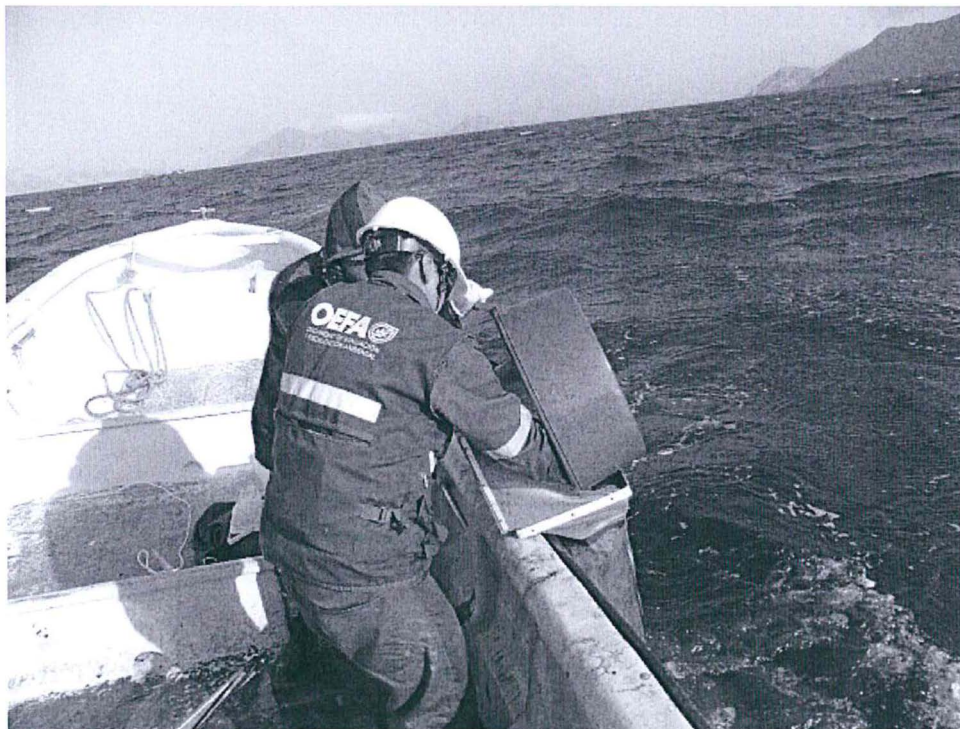
Fotografía N° 4. Toma de muestras de sedimento para macrobentos.
