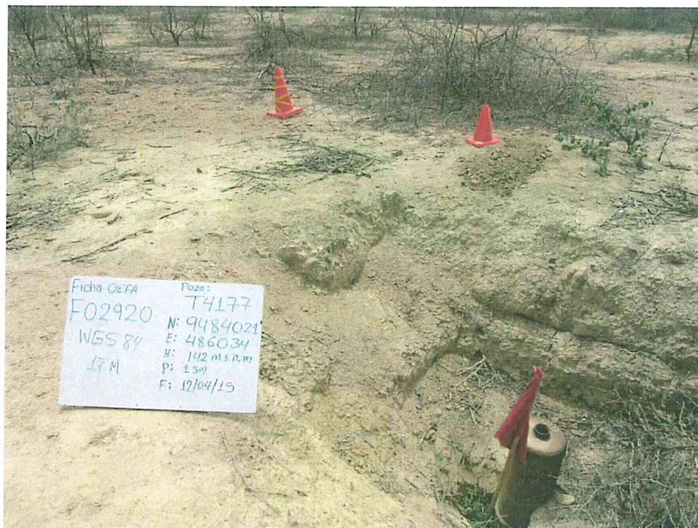
Fotografía N° 1. Vista del pozo T4177 ubicado dentro de un hoyo, se observa el tapón reductor abierto al ambiente.
