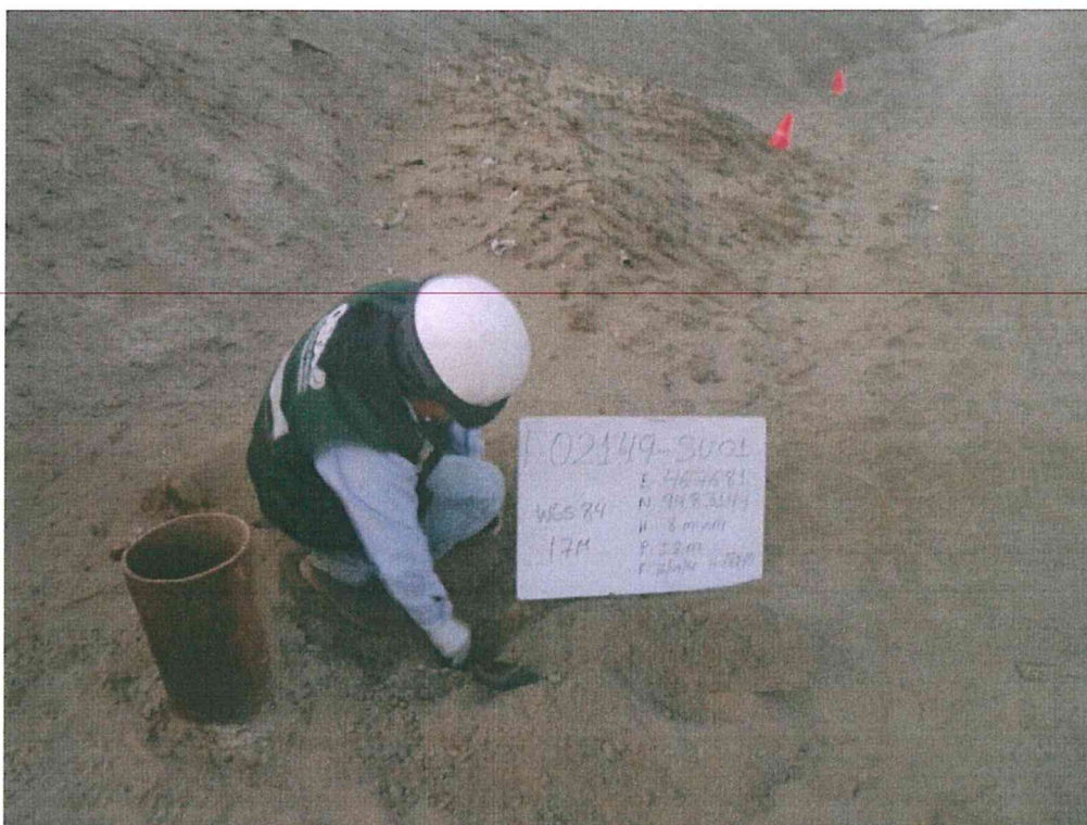
Fotografía N° 3. Toma de muestra de suelo en el punto F02149-SU01, ubicado a 0,5 m aproximadamente, al este del Pozo T_363.
