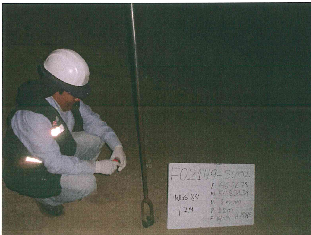
Fotografía N° 4. Toma de muestra de suelo en el punto F02149-SU02, ubicado a 3 m aproximadamente, al sur del Pozo T_363.
