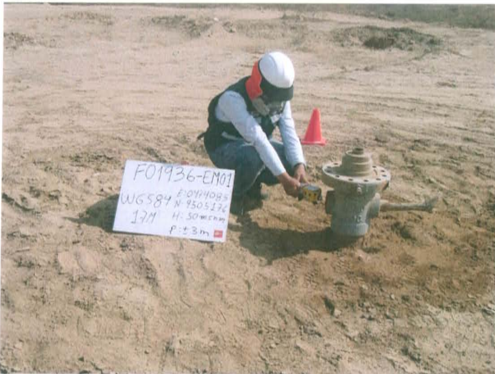
Fotografía N° 4. Medición en el punto F01936-EM01, ubicado en la fuente de emisión en boca del Pozo LJ_X2.
