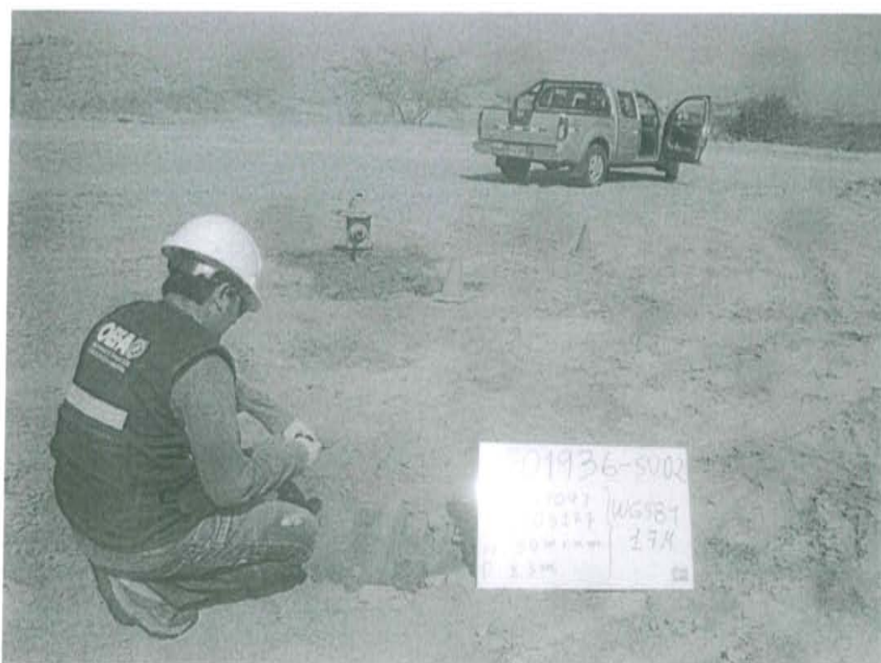
Fotografía N° 2. Toma de muestra de suelo en el punto F01936-SU02, ubicado a 5 m aproximadamente del Pozo LJ_X2.
