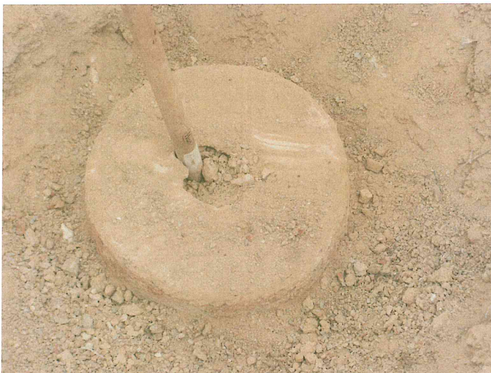
Fotografía N° 1. El Pozo A_178 fue ubicado a 0,4 m de la superficie con una cubierta metálica de 11 pulgadas de diámetro, cuyo centro se encontró con un agujero donde posiblemente se encontraría la varilla de fierro.
