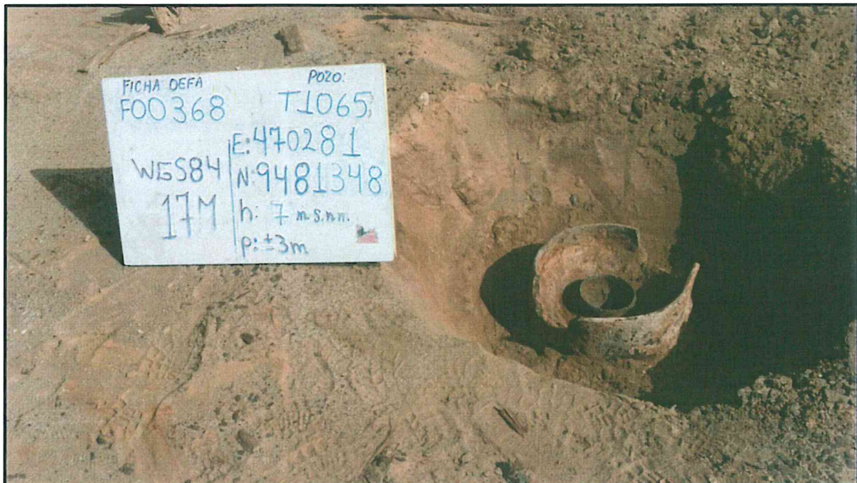
Fotografía N° 1. Pozo con código PERUPETRO T1065, se encontraba enterrado aproximadamente a 0,40metros por debajo del nivel del suelo, presenta dos casing concéntricos.
