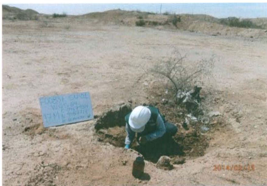
Fotografía N° 3. Punto de muestreo de suelo F00837-SU01, a 0,70 m del casing y a una profundidad de 0,45 m de la superficie del suelo.
