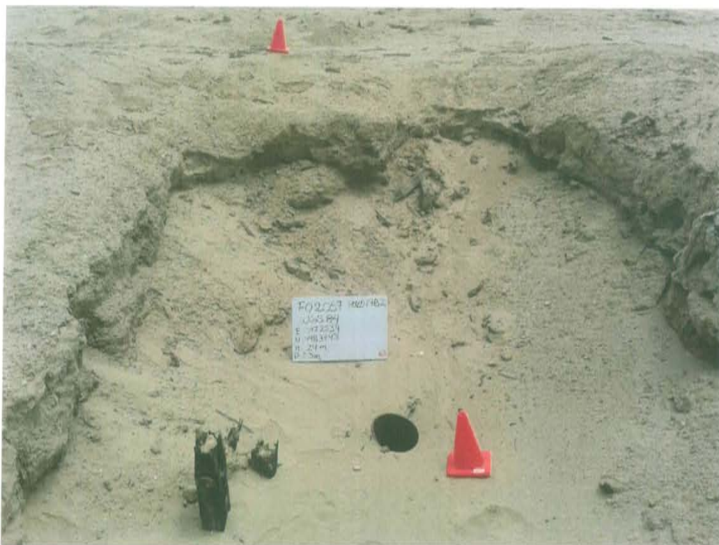
Fotografía N° 1. Se observa casing a nivel de la superficie del suelo y se encuentra abierto al ambiente.
