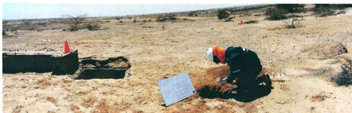
Fotografía N° 4. Toma de muestras de suelo en el punto F01759-SU01 ubicado a 3-m del pozo T2908, donde el suelo presenta hidrocarburos
