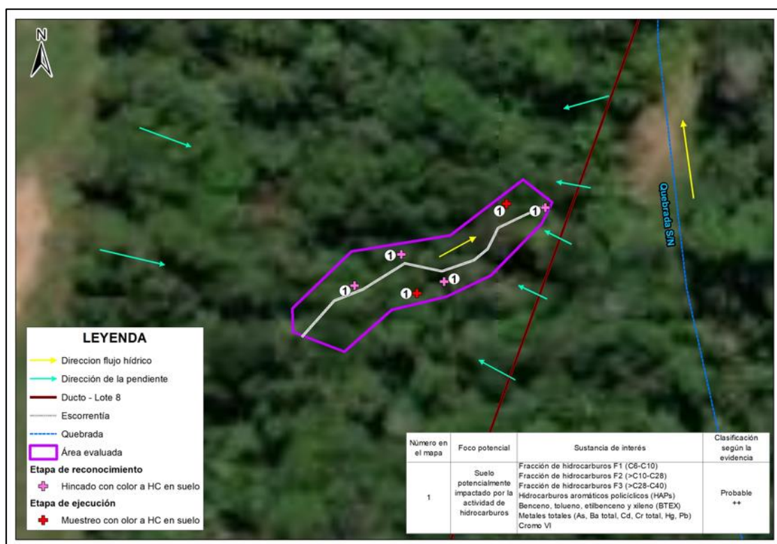
Figura 3.2. Focos potenciales de contaminación en el sitio S0560 HC: Hidrocarburo.
