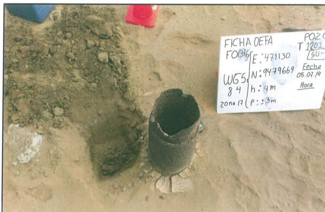
Fotografía N° 2. Pozo con código PERUPETRO T1202; con casing de 0,3 m de altura que sobresale desde la superficie del suelo.
