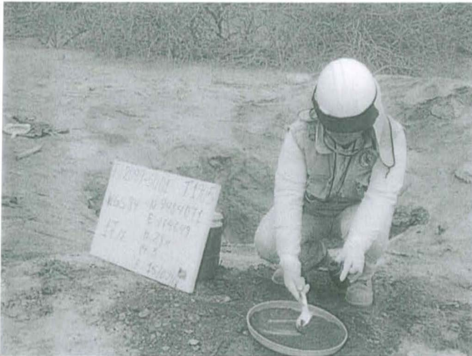
Fotografía N° 1. Toma de muestra de suelo en el punto F02099-SUO1, ubicado a 2,1 m aproximadamente del Pozo T1905.
