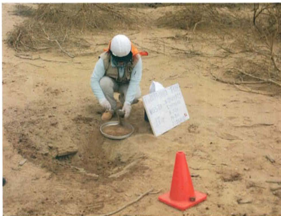
Fotografía N° 4. Toma de muestra de suelo en el punto F02099-SUO2, ubicado a 6 m aproximadamente del Pozo T1905.
