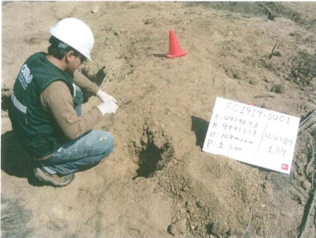
Fotografía N° 03.- Toma de muestra de suelo en el punto F01914-SU01, ubicado a 2 m aproximadamente del Pozo T3620.
