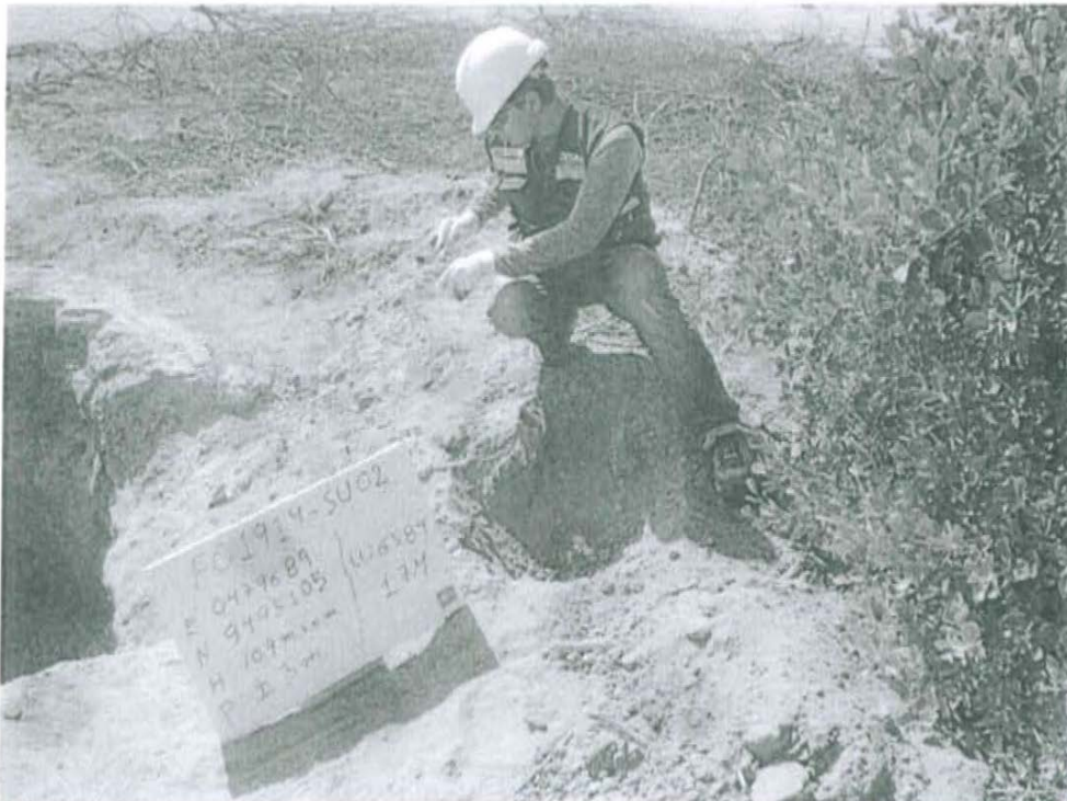
Fotografía N° 2. Toma de muestra de suelo en el punto F01914-SU02, ubicado a 2,5 m aproximadamente del Pozo T3620.
