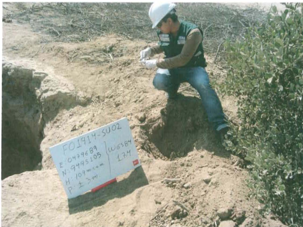
Fotografía N° 03.- Toma de muestra de suelo en el punto F01914-SU02, ubicado a 2,5 m aproximadamente del Pozo T3620.
