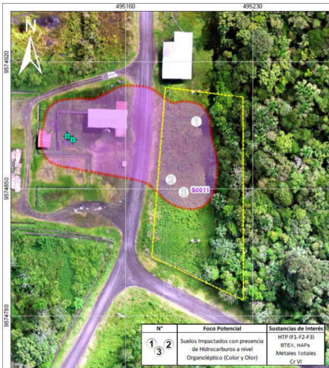
Figura 3.5. Focos potenciales de contaminación en el sitio S0011
