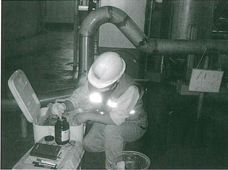
Fotografía N° 5: Toma de la muestra para Aceites y Grasas (A&G) de la muestra compuesta de Agua Residual (Agua de Bombeo) y la aplicación del persegante H_2SO_4 Punto de monitoreo AB
