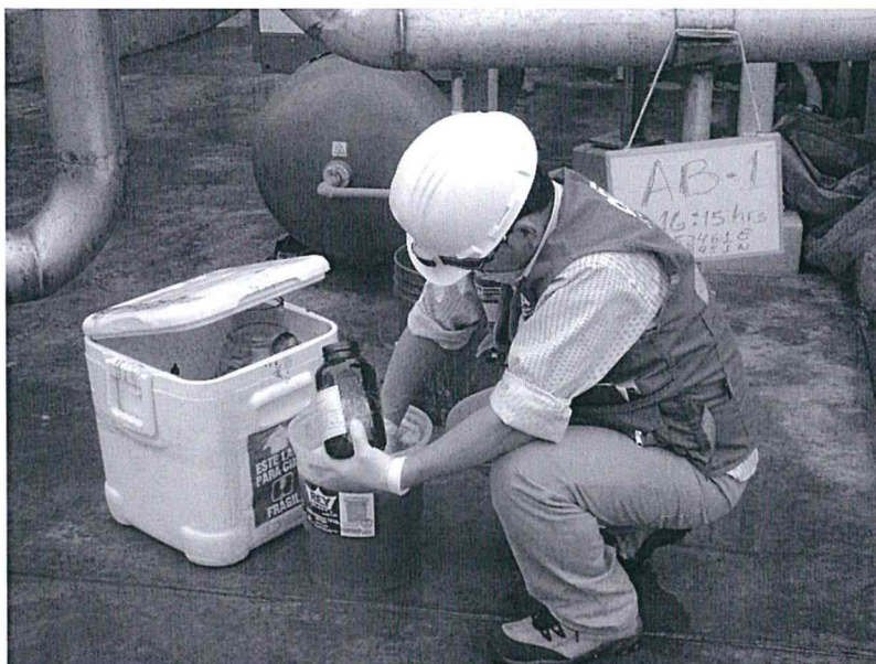
Fotografía N° 4: Toma de una muestra compuesta para Demanda Bioquímica de Oxígeno ( DBO_5 ), Aceites y Grasas (A&G) y Sólidos Suspendedos Totales (SST). Punto de monitoreo AB
