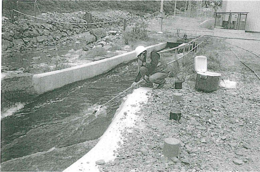
Fotografía N° 5. Toma de Muestra de Efluente del Punto ME-1.
